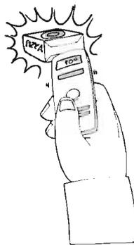
Infravermelho sem contato com o alimento
